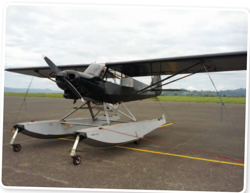
▲SeaPlane：水上飛機配備有別於一般的輪子，下方的兩個裝置可以讓飛機在水面上漂浮
