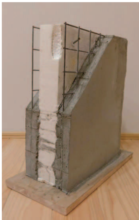
3D牆構造牆面
